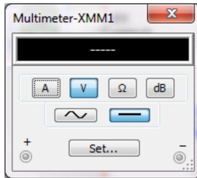
pada praktek ini, kita akan mengukur parameter nilai tegangan dari komponen resistor R1 sehingga tombol fungsi pengukuran kita pilih “ V”.
